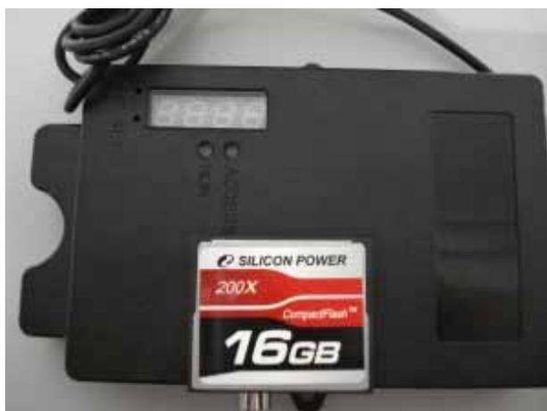
図2 新開発の防犯カメラシステムユニット（手前が本体内部に装着するメモリカード）
